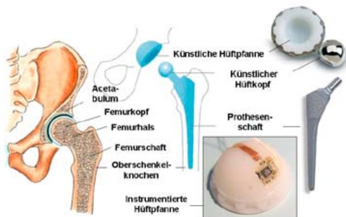
Komponenten des natürlichen und künstlichen menschlichen Hüftgelenks. Quelle: Fraunhofer IZM.
