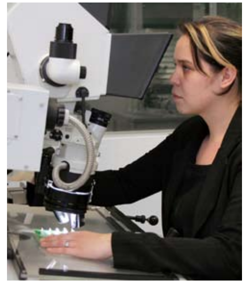
Optische Inspektion von Lötstellen. Quelle: ZAVT.
