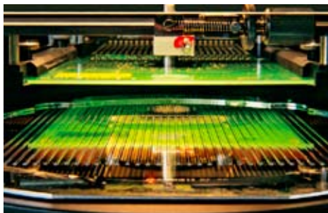
Charakterisierung von elektrischen und optischen Parametern durch On-Wafer-Messtechnik. Quelle: EZconn Europe GmbH.
