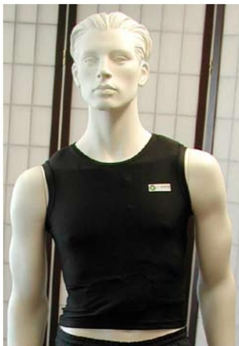
Abbildung 1: Sensorshirt mit integrierter waschbarer Elektronik. Quelle: Fraunhofer IPMS.
