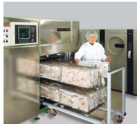
Steriplas-Anlage zur Gas-Plasma-Sterilisation.
