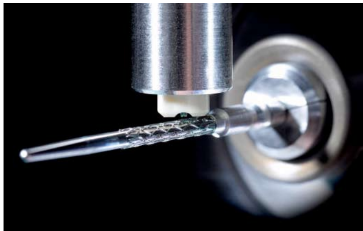
Beschichtung von Kleinststrukturen: Ein Stent auf einem Dorn wird mit dem Inkjet-Prozess beschichtet. Quelle: microdrop Technologies GmbH.
