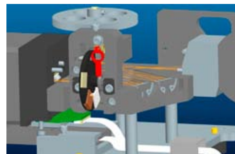
Elliptec Motor X15G (rot) als Antrieb im PLATINblue UV1. Quelle: Elliptec Resonant Actuator AG.
