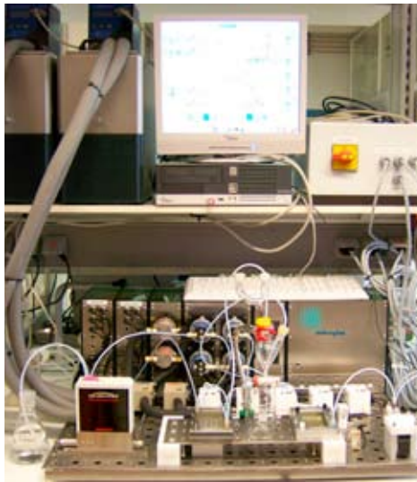
Mehrzweckanlage mit Reaktionsplatte im Vordergrund. Quelle: mikrogas chemtech GmbH.
