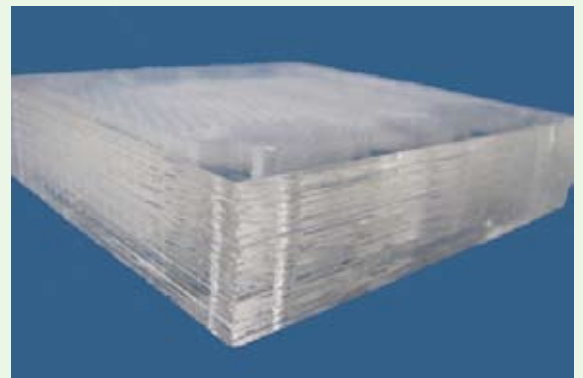
Zwei Ansichten eines von der ix-factory GmbH produzierten Mikroreaktors aus Glas, bestehend aus 20 gebondeten Glassubstraten. Quelle: ix-factory GmbH.
