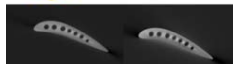
Vergleichs-CT einer Turbinenschaufel: Die 300 kV-Microfocus-Röntgenröhre (links) ermöglicht deutlich artefaktärmere Scans als herkömmliche 240 kV-Microfocus-Röntgenröhren (rechts). Quelle: GE Sensing & Inspection Technologies GmbH.
