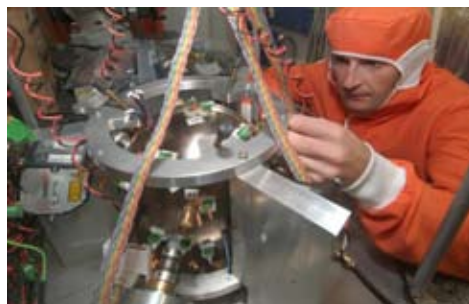
Verkabelung der Reaktionssphäre. Quelle: CSEM.
