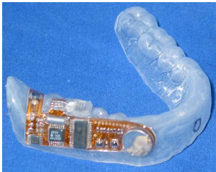
Kauschiene zum Nachweis der Machbarkeit. Quelle: Fraunhofer IBMT.
