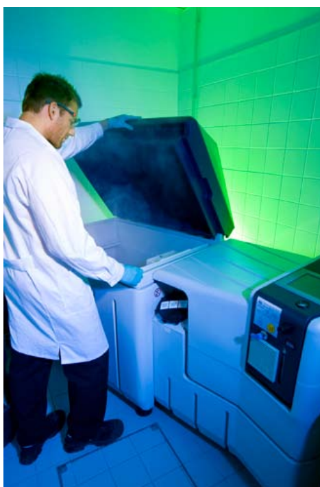
Testkammer für Salzsprühtests und genormte Korrosionsuntersuchungen. Quelle: Happy Plating GmbH.
