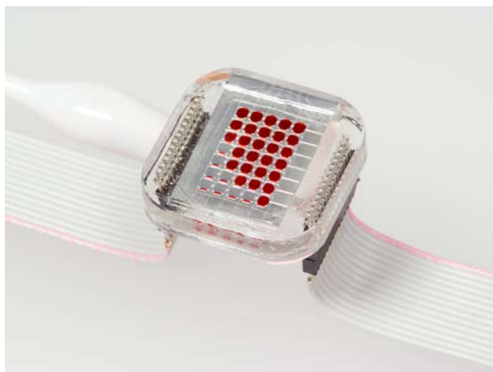
Elektrobenetzung. Quelle: Bartels Mikrotechnik GmbH.
