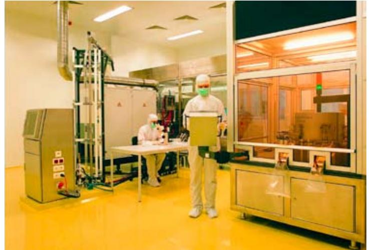
Montage und Qualitätsprüfung medizintechnischer Mikroteile unter GMP-Bedingungen in den Reinräumen von Boehringer Ingelheim microParts. Quelle: Boehringer Ingelheim microParts GmbH.
