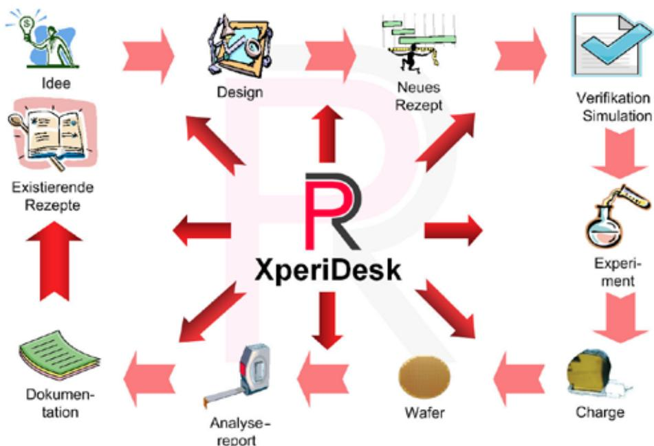
Abbildung 1: Prozessentwicklungszyklus in der siliziumbasierten Dünnschichttechnik. Quelle: Process Relations GmbH.
