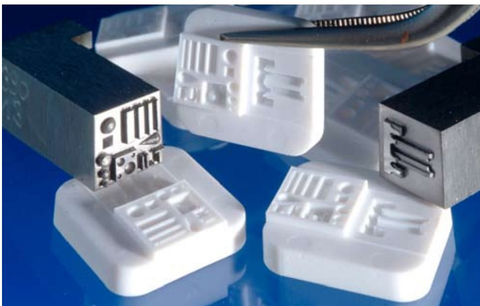
Ultrakurzpuls laser ermöglichen die flexible Herstellung von Mikrospritzgüsseinsätzen mit Geometrien < 100 \mu\text{m} in harten Werkzeugstählen. Quelle: Fraunhofer-Institut für Lasertechnik ILT.
