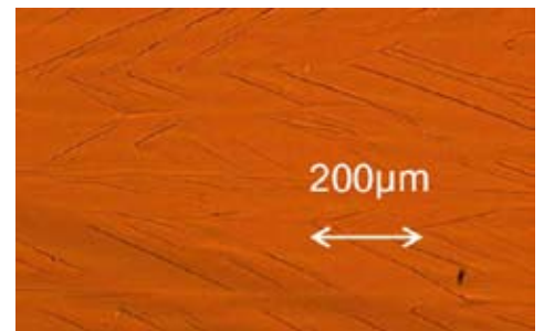
Abbildung 3: Si-Kristallite in einer auf Glas aufgetragenen 500 nm-Si-Schicht. Quelle: IPHT Jena/CiS (G. Andrá, J. Plentz, A. Gawlik, E. Ose, F. Falk, K. Lauer, veröffentlicht im Rahmen der 22. European Photovoltaic Solar Energy Conference, Mailand, Italien, 2007).
