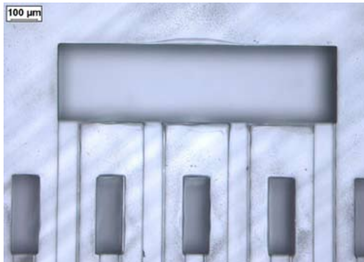
Strukturausschnitt mit geprägten Kanälen und laserstrukturierten Durchkontaktierungen. Quelle: 3D-Micromac AG.
