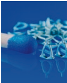
Durch Mikro-Metallpulver-spritzguss gefertigte Steigbügel mit kleinster Wandstärke von 280 Mikrometern (Kooperation mit Krämer Engineering). Quelle: Fraunhofer IFAM.
