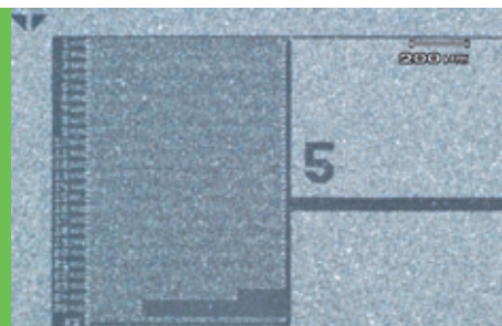
Mikrostrukturierter Temperatursensor (Pt1.000 auf 1,25\text{ mm} \times 1,6\text{ mm} ). Quelle: UST Umweltsensortechnik GmbH.
