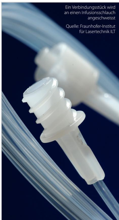
Ein Verbindungsstück wird an einen Infusionsschlauch angeschweisst
