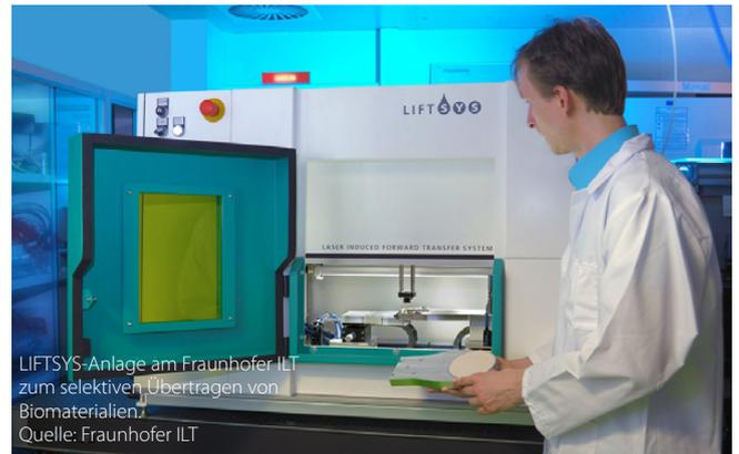
LIFTSYS-Anlage am Fraunhofer ILT zum selektiven Übertragen von Biomaterialien.
