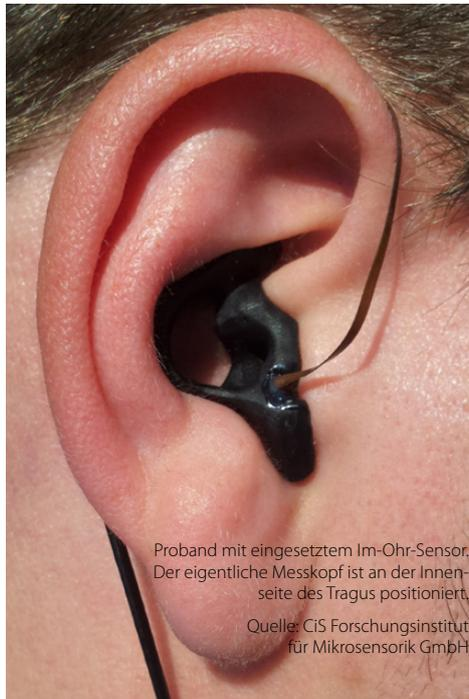
Proband mit eingesetztem Im-Ohr-Sensor. Der eigentliche Messkopf ist an der Innenseite des Tragus positioniert.
